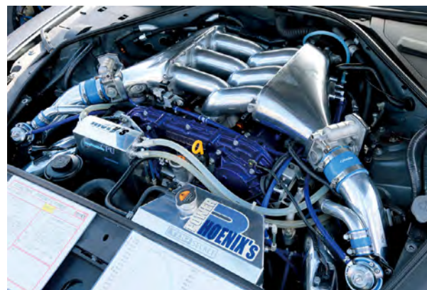
VR38のエンジンリフレッシュプランも好評。エンジン内部を強化した上でオリジナルのTD-06SH改24Vタービンをセットしたこの車両は、なんと約1,200psを発揮
