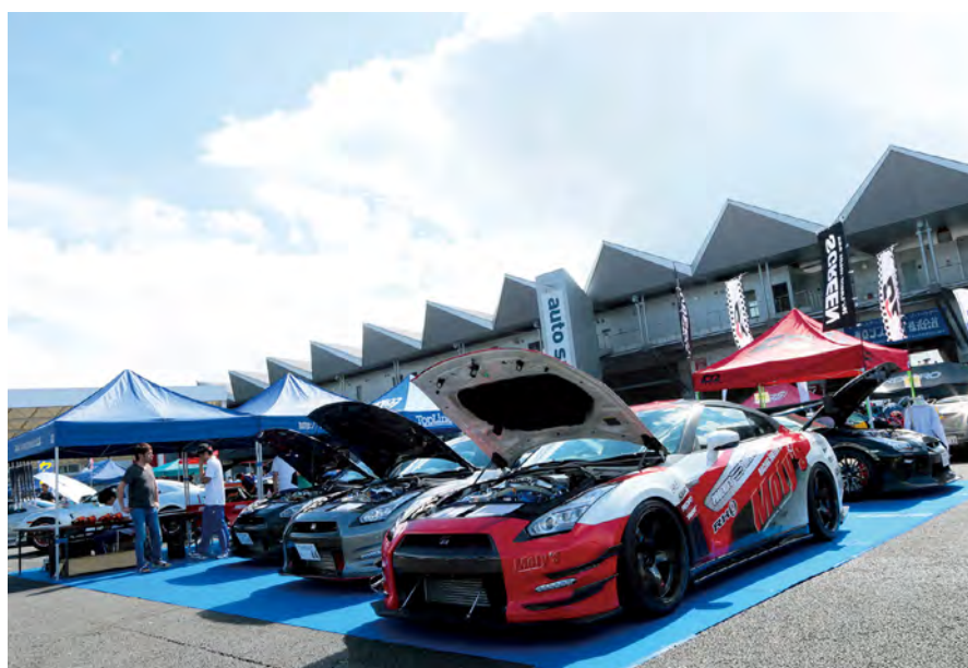
R35の富士スピードウェイ最速を目指して製作が進められる手前のR35は、TD-06SH改27Zタービンを装着した1,000ps仕様。GR6ミッションも強化済みで、不安なくアクセルを踏み込める。足まわりはアラゴスタの3WAY車高調をセットした
