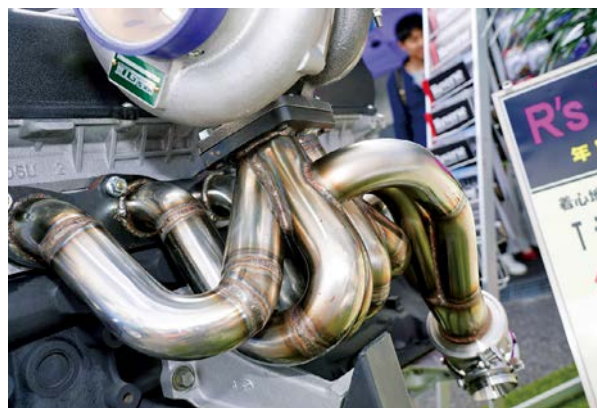
展示されていたエキマニにはHKSのGTⅢタービンを装着。その位置が若干フロント寄りになっている。まだ完成したばかりで正式名称や価格は近日中に発表の予定
