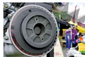
専用の分度器を使わずにバルブタイミングの計測が可能。セッティングの手間を大幅に簡略化する優れたアイテム
