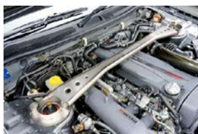
第2世代のGT-Rに向け新たにリリースされたタワーバーにも注目だ。純タン製で重量はわずか1.5kg！
