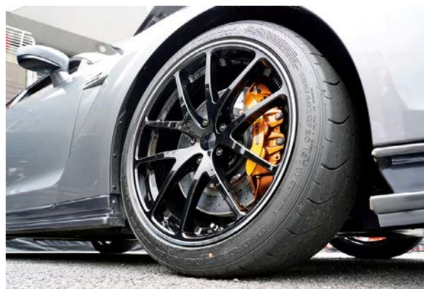
サイズはフロントが10J×20で、リアが10.5J×20という設定だ。落ち着いたブラックのフェイスに、ダイヤカットとマシニング加工によるNISMOロゴがよく映える
