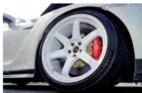
20インチのボルクレーシングTE37の奥から顔を見せるのは、エンドレスのキャリパーキットで前後6ポットだ
