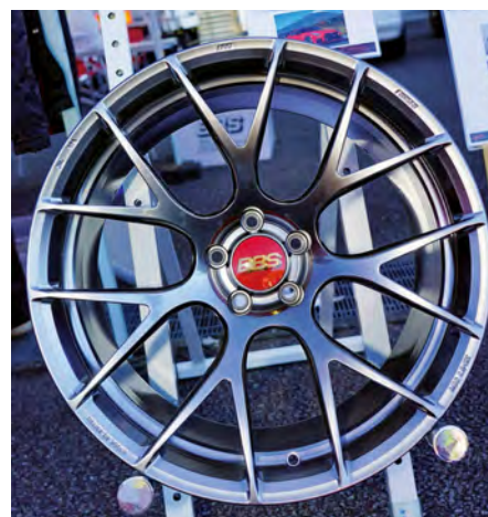
BBSの「RE-V7」をR35専用にMCRがプロデュース。サイズはフロントが10.5J×20+25、リヤが11J×20+10で鍛造1ピース。サーキット走行を想定し強度と軽さを追求した
