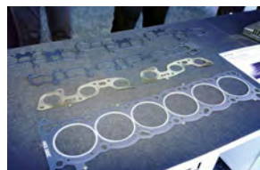
ヘッドに流入する冷却水の通路のサイズを最適化したグロメット構造のRB用ヘッドガスケットにも注目したい
