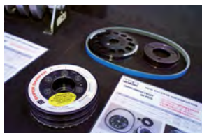
ダンパーがクランクシャフトの振動を軽減。大径ウォーターポンプブリーとセットで冷却性も向上するアイテム
