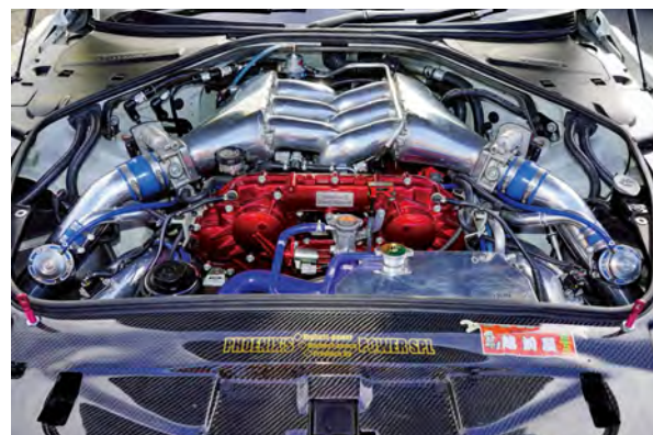
HKSのキットで4.3ℓに排気量アップし、トラストのTD06SH-20RXタービンを組み合わせる。オリジナルのダブルオイルクーラーシステムを搭載しサーキット走行にも対応している
