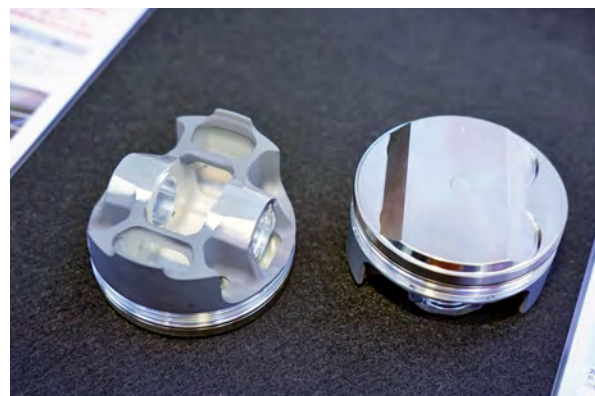
ブリッジ コンセプト デザインのピストン。モリブデンとフッ素樹脂による2層式コーティングの採用など、HKSのノウハウを注ぎ込みつつ5軸削り出しよりも低価格
